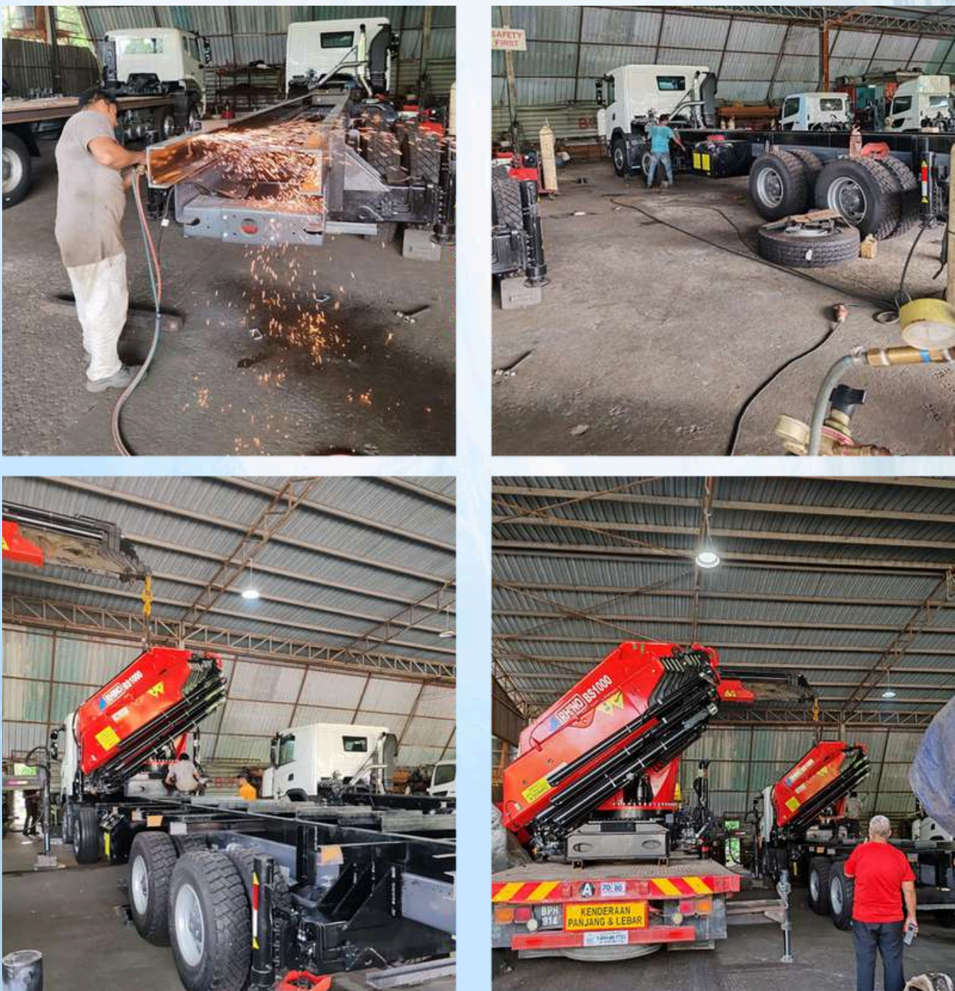
Gambar Pemasangan Lori Kren
