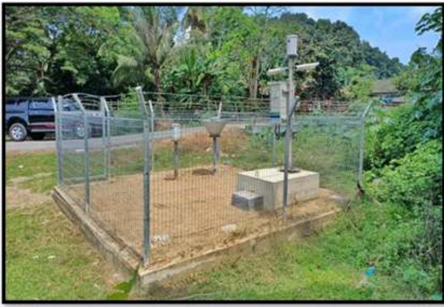
Gambar 3: Stesen Hujan dan Aras Air di Sg. Batang Tampin di Tanjung Rimau
