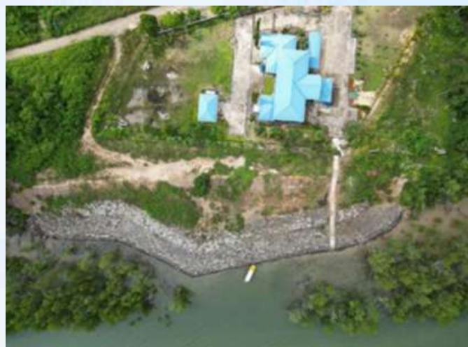
Gambar 2 : Pembinaan Rock Revertment yang telah siap di kawasan balai polis Wallace Bay
