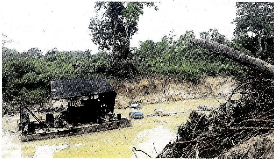
Mesin penyedut pasir yang digunakan untuk operasi sedut pasir di Sungai Terentang.
