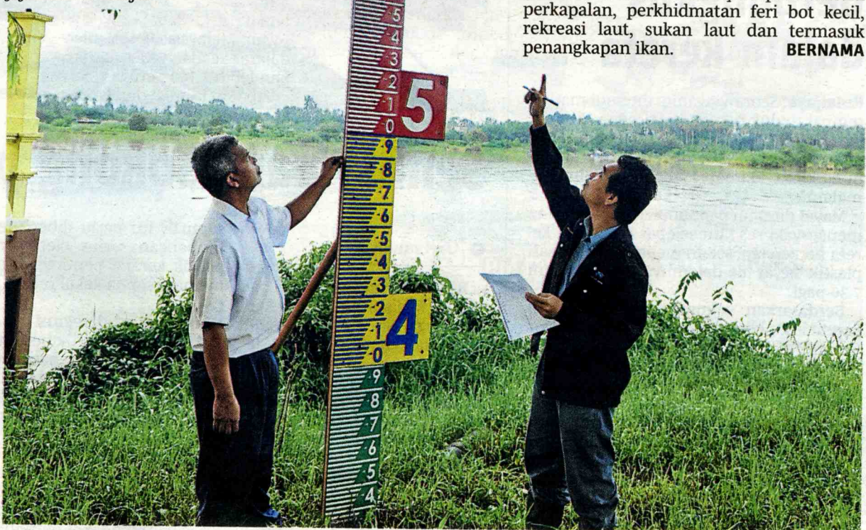
Pegawai Juruteknik bahagian Sumber Air dan Hidrologi Jabatan Pengairan dan Saliran (JPS) Kelantan memeriksa Tolok Lurus bagi membaca aras air sungai ketika banjir.
